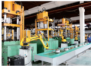
智能机器人厨具流水线
